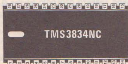
Fig. 1 L'integrato impiegato per questo orologio dispone di 28 piedini ed è siglato TMS3834 oppure TMX3834.
